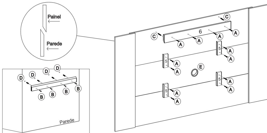
FINALIZE A FIXAÇÃO COM AS JUNÇÕES DE VISTA E ADICIONE O KIT FIXADOR DE PAINÉIS
