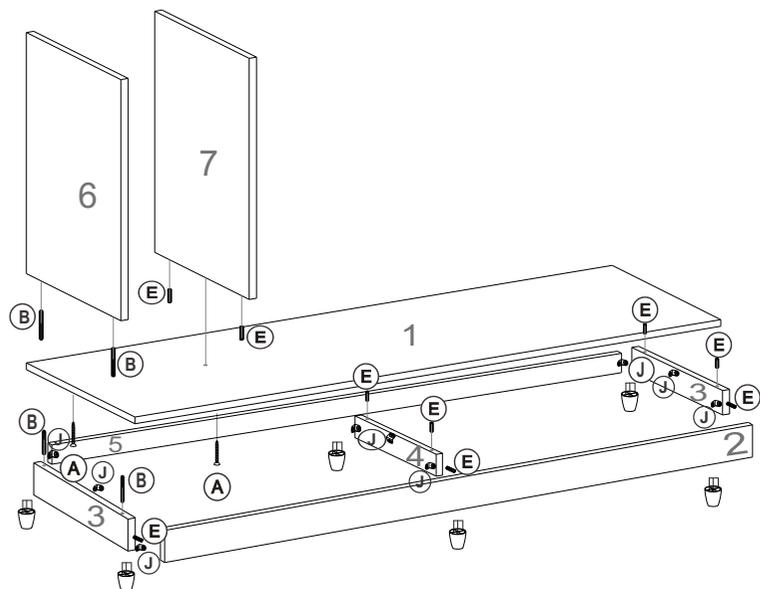
INICIE A MONTAGEM PELA BASE , PEÇAS INFERIORES , LATERAL E DIVISÃO ESQUERDA
