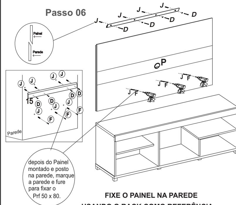
FIXE O PAINEL NA PAREDE USANDO O RACK COMO REFERÊNCIA.
